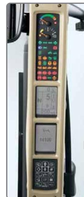
El cuadro de instrumentos situado en el pilar A, junto con un monitor de prestaciones, ofrece información sobre las funciones y los datos principales a simple vista para simplificar su consulta.
